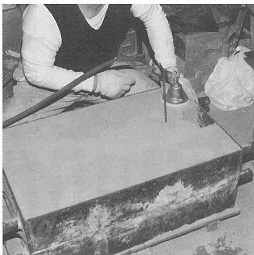
3 外型を炭酸ガスで固める
