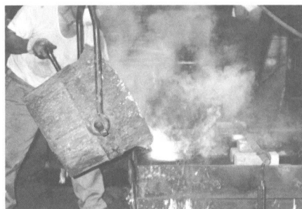
③ 溶解した金属「湯」を鋳型に 流し込む
