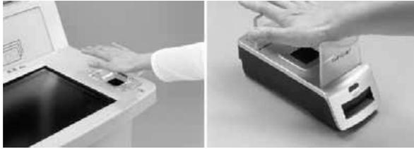
図IV-2B 富士通の手のひらタイプの静脈認証機器
