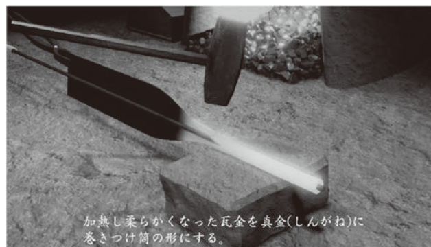
図3 工程a：鍛造による銃身の成形
