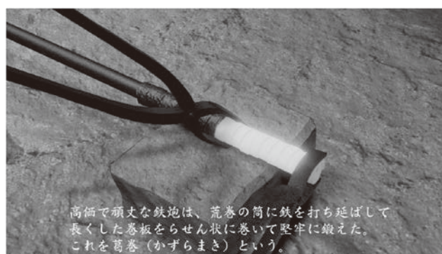
図4 工程b：葛巻による銃身の強化
