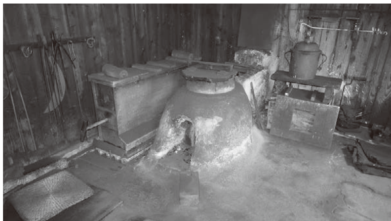
図14 現役の炉とフィゴ（水野鍛錬所）
