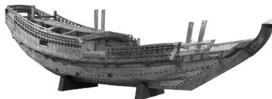
図3 弁才船民吉丸の1/10奉納雛形
