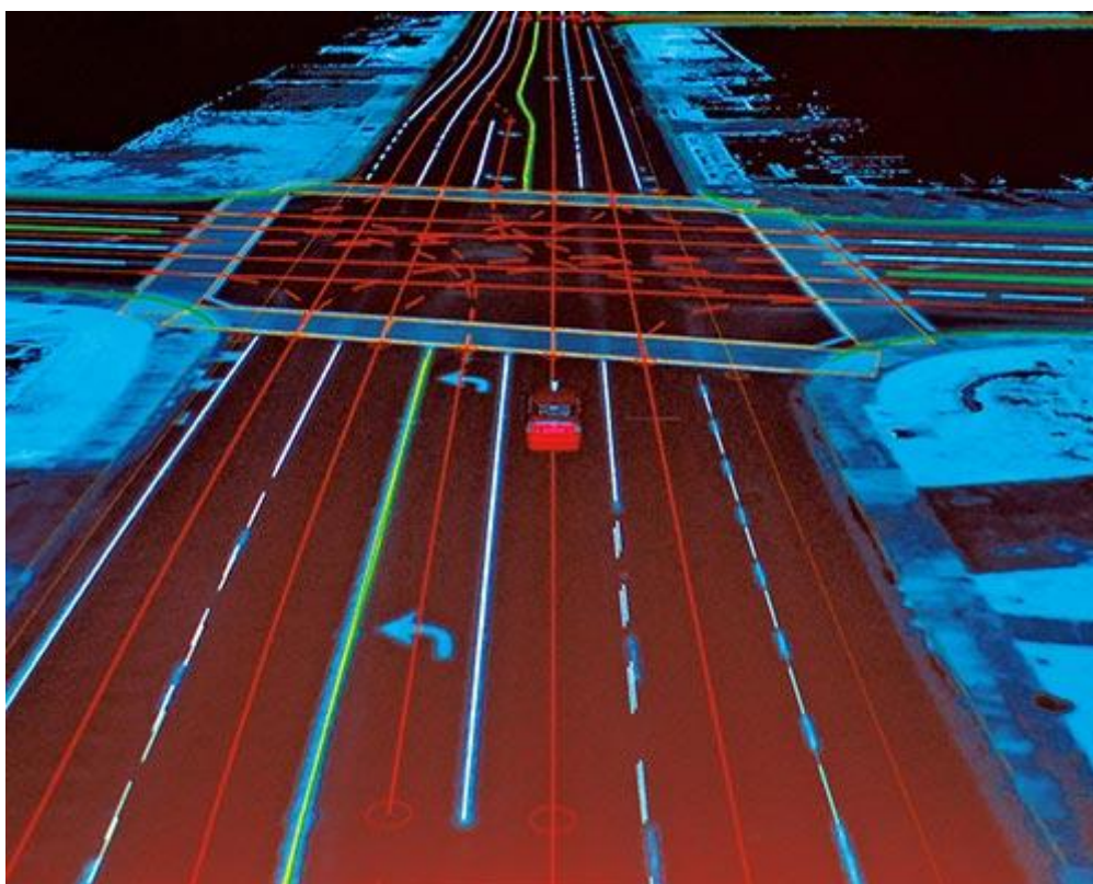
図 1.7 自動運転のための道路電子地図データ
