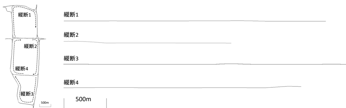
図 4.36 生成した高架道路橋の SXF 縦断図
