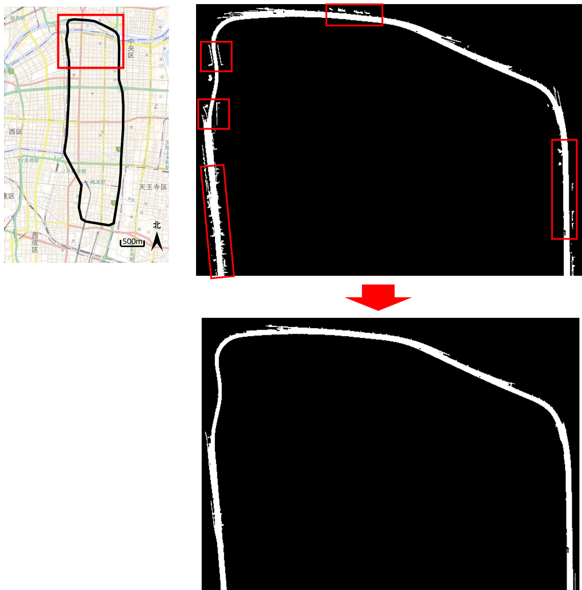
図 5.10 MMS Type-S の点群データのノイズ除去の結果 (1)
