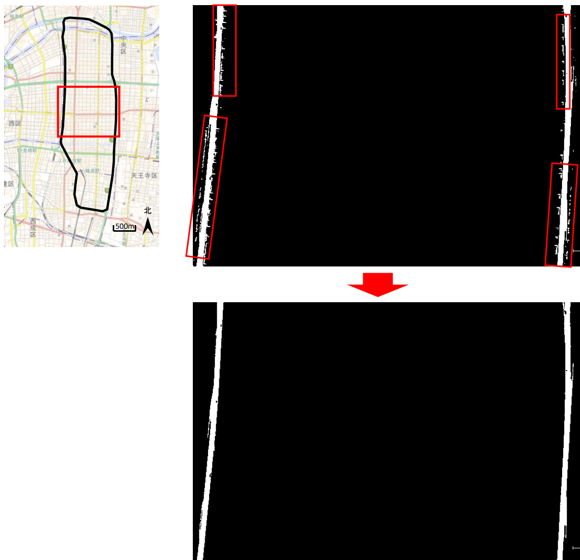
図 5.12 MMS Type-S の点群データのノイズ除去の結果 (3)
