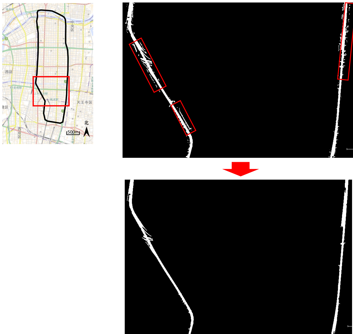
図 5.13 MMS Type-S の点群データのノイズ除去の結果 (4)
