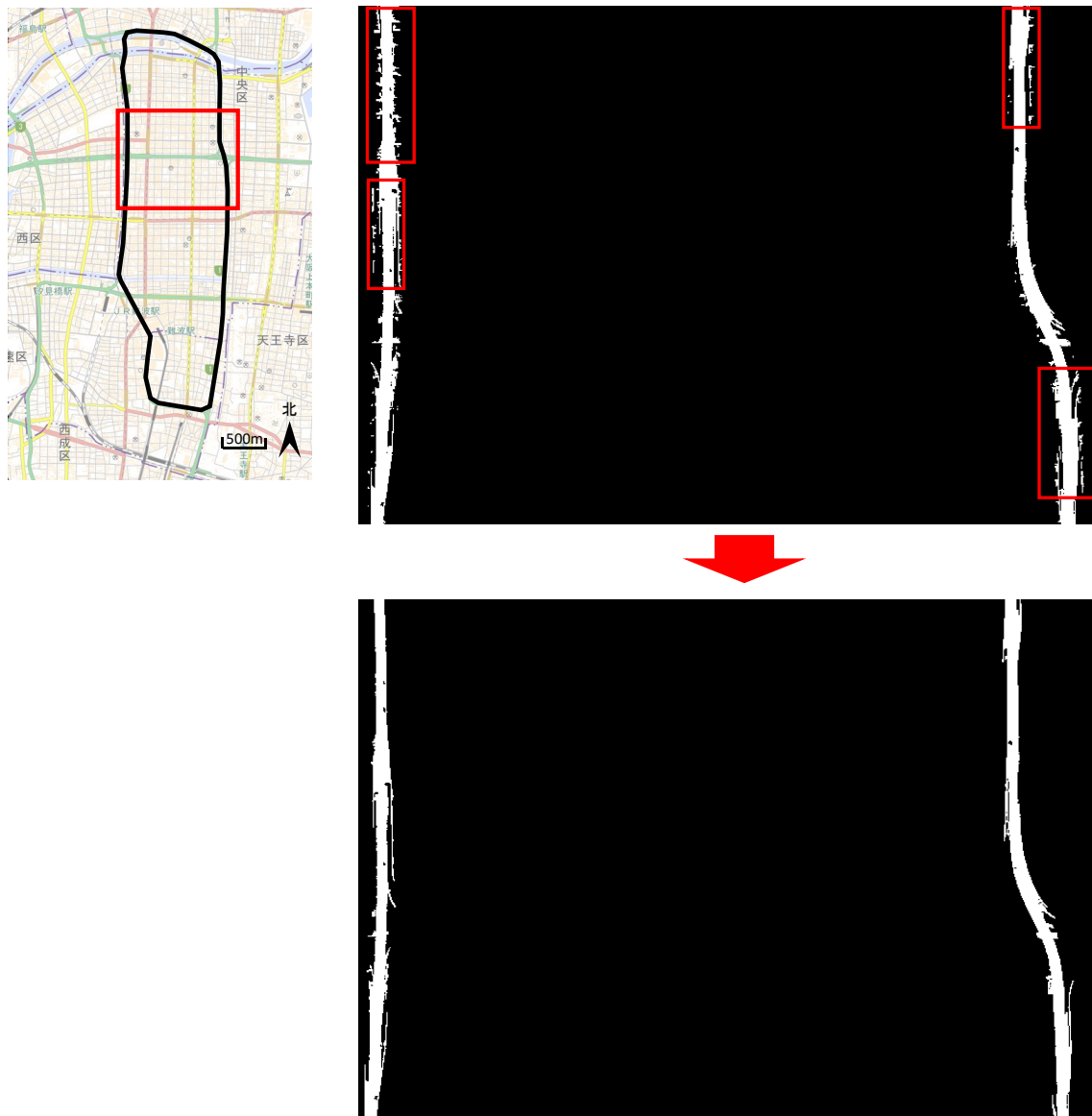
図 5.11 MMS Type-S の点群データのノイズ除去の結果 (2)
