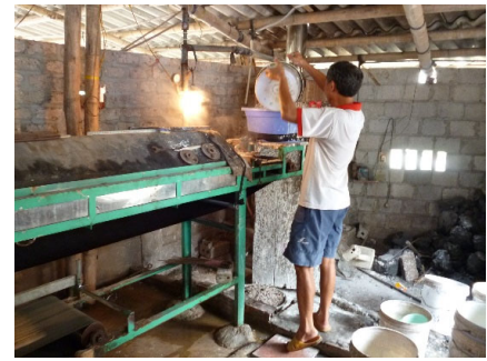
図 9-7 自動成形機に充填されるライスペーパーの生地のもと (2014 年ライスペーパーの製造世帯の工場にて筆者撮影)
