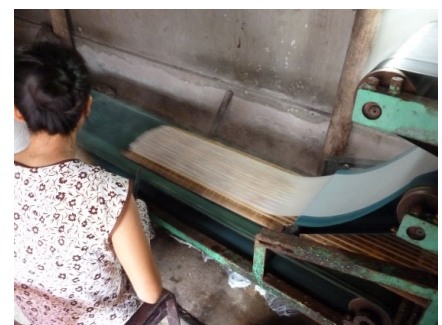
図 9-8 竹網板に自動で置かれるライスペーパー (2014 年ライスペーパーの製造世帯の工場にて筆者撮影)
