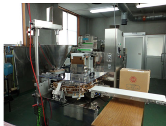
図1-3 東亜工業の自動餃子製造機 (2012年9月3日筆者撮影)
