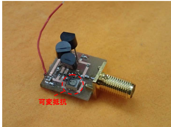
図 3-15 負性キャパシタンス値の調整が可能な NIC 回路の試作モデル
