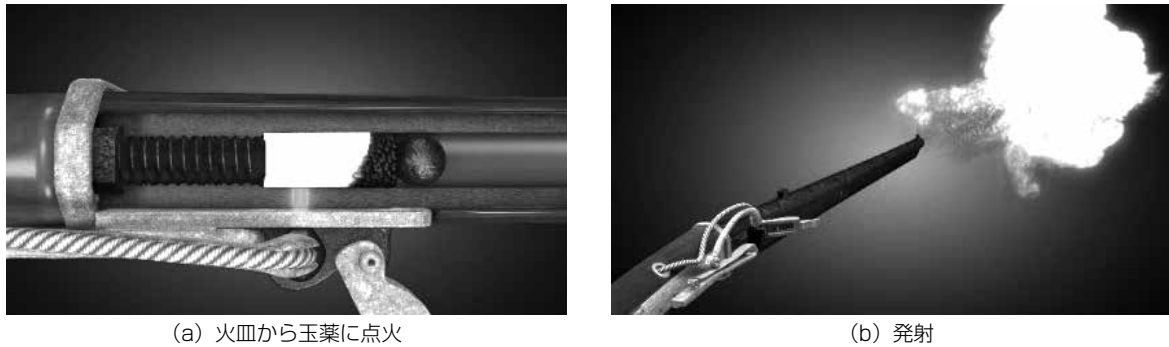
図15 発射のメカニズムと発射シーン
