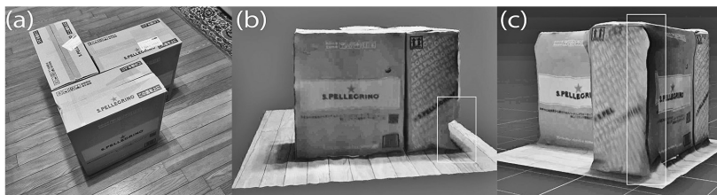
図13 室内の段ボール3箱LiDAR測量例
