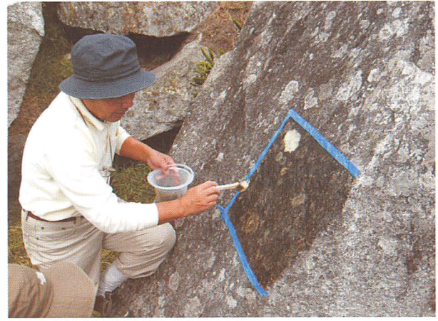
Fig. 20 地衣類除去剤の応用実験
