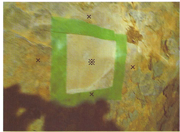
Fig. 7 周波数測定時の打診位置例
