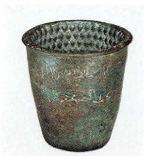
Fig. 42 吹きガラス技法の金属製の鋳型
