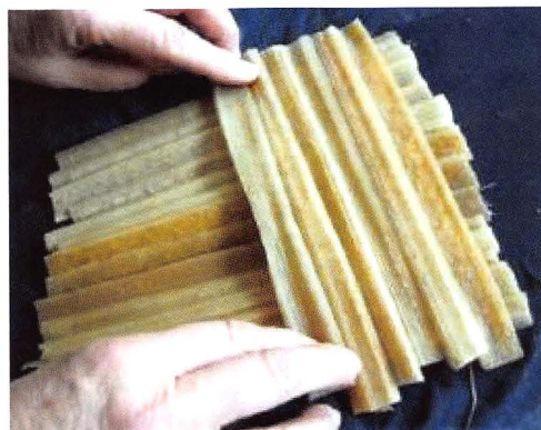
(e) ストリップの最初の層を置いた後、直角に置かれる2つ目の層
