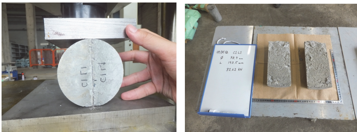
(b) 割裂引張強度試験
