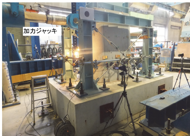
図 5.6 静的打継目破壊試験状況 (供試体 No.3)
