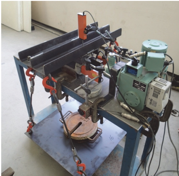
図 4.37 一面せん断すべり試験状況
