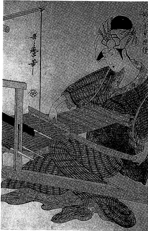
14. 『婦人手業操鏡』にみえる地機〔西日本型〕 15. 『女風俗品さだめ』にみえる地機〔西日本型〕
