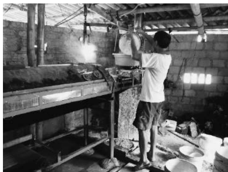
図7 ライスペーパーの生地のもとを自動成形機に充填する (2014年筆者撮影)
