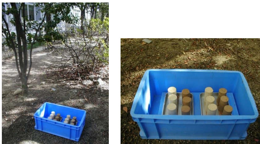
写真 3.1 野外曝露試験供試体設置状況
