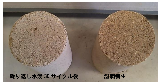
写真 6.1 繰り返し水浸 30 サイクル後の供試体と湿潤養生供試体の比較例
