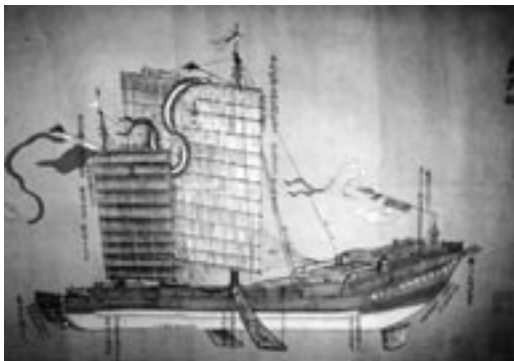
平底型海船 沙船の例 原画：平戸松浦史料博物館蔵「唐船之圖」
