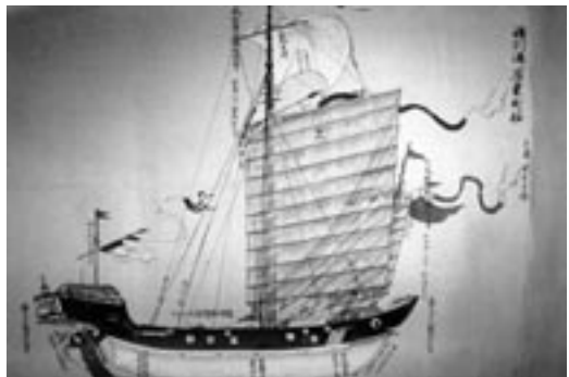
尖底型海船 鳥船の例 原画：平戸松浦史料博物館蔵「唐船之圖」
