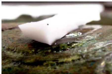
写真 29 発泡スチロールの癒着
