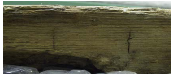
写真12 断面に発生したクラック
