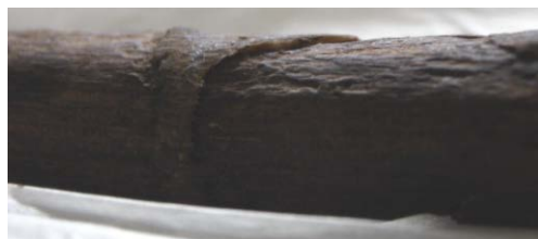
写真 12 補填部の軟化・膨潤
