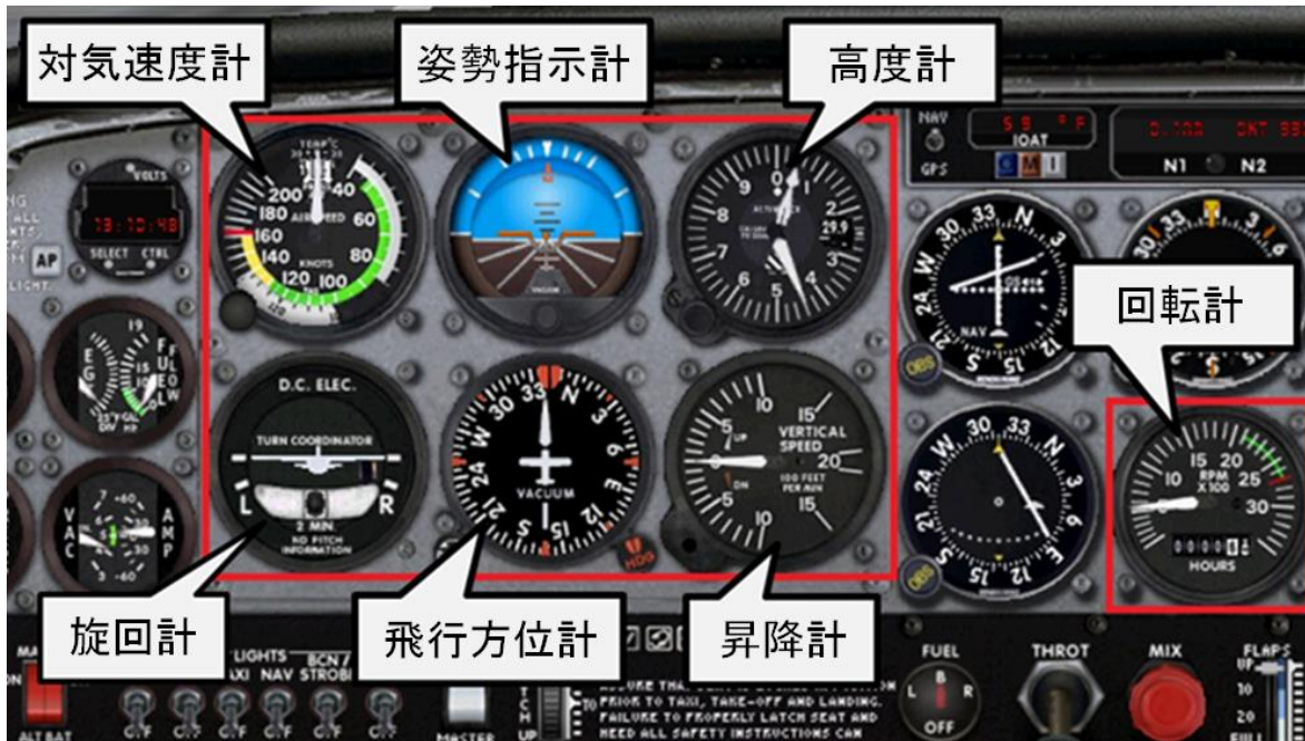
図 2-2 操縦計器（Cessna C172 Skyhawk）
