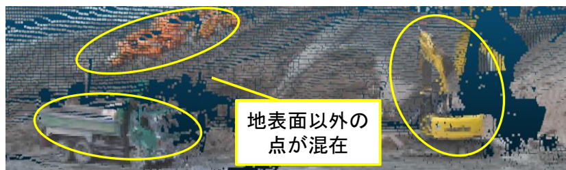
図 2-8 地上レーザスキャナで計測した地表面の点群データ
