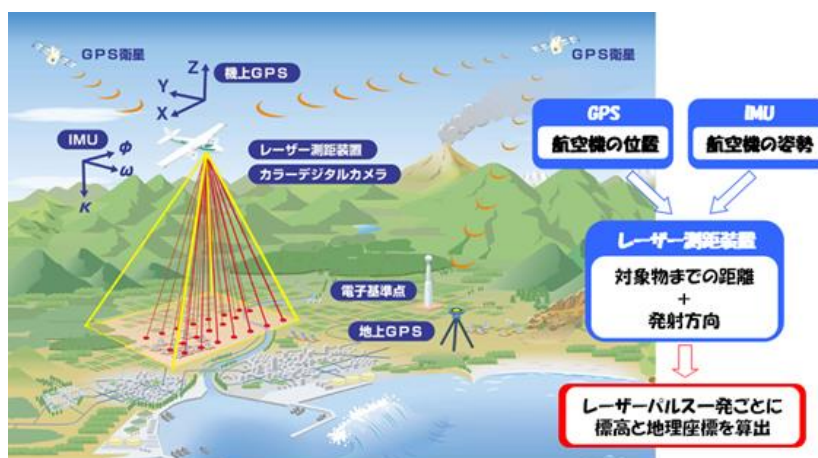
図 2-5 航空レーザ測量による点群データの取得方法
