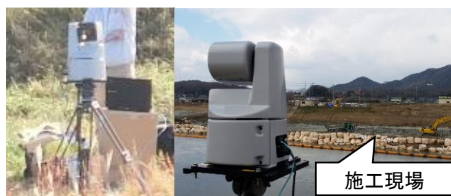
図 4-11 地上レーザスキャナの計測風景
