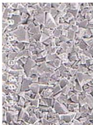
図 2-1. 超硬合金断面組織写真(タングステンカーバイド粒径 0.8 μm、Co 量 8%)
