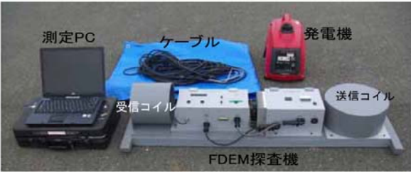
写真 5.7 FDEM法の測定機材
