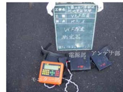
写真5.4 VLF-EM法測定装置
