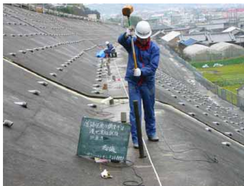
写真 7.2 弾性波探査起振状況
