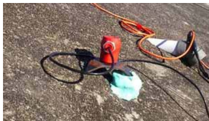
写真 7.2 弾性波探査起振状況
