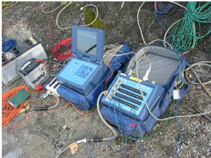
写真5.2 比抵抗探索測定装置 McOHM Profiler4
