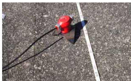
写真 7.3 高密度表面波探査受振器設置状況
