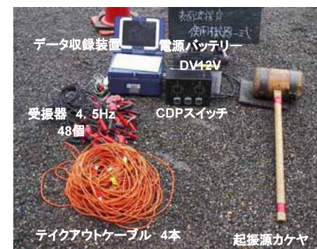
写真7.1 高密度表面波探査使用機器
