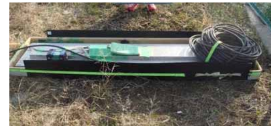
写真6.5 連続波地中レーダ低周波アンテナ（大型タイプ）
