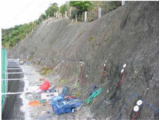
写真 5.1 ジオゲル電極と測定状況 (地点 (2))
