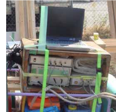
写真6.3 連続波レーダ制御収録部
