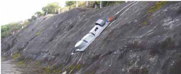
写真 5.8 FDEM探査の測定状況
