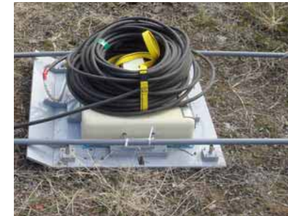
写真6.4 連続波地中レーダ高周波アンテナ（小型タイプ）
