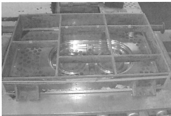
図4 鑄型枠の取り付け状況
