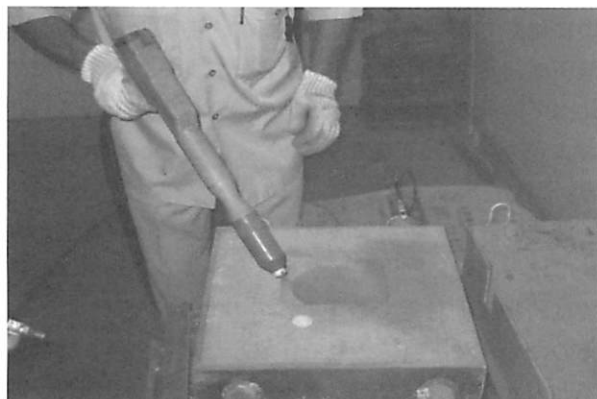
図6 耐熱塗料の塗布
