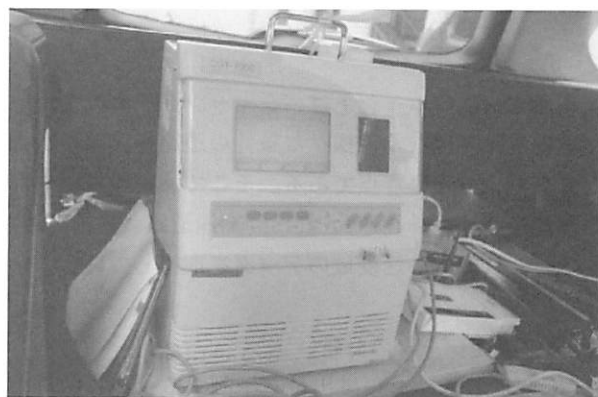
写真-1 CO 2 濃度測定装置
