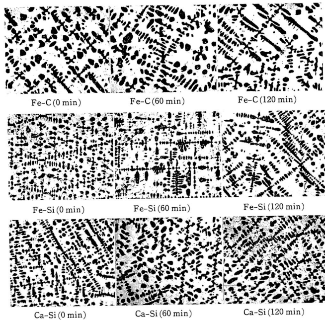
図4 各試料ごとの溶湯保持に伴う初晶 \gamma 組織の変化 ( \times 26 \times 1/2 )
