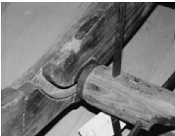
写真20 鬼車を取り外しできるように溝をつけた木枠
