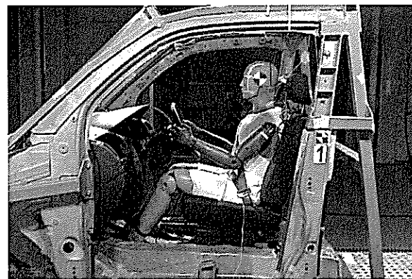
図 4.8 スレッド装置によるダミー衝突試験の概況
