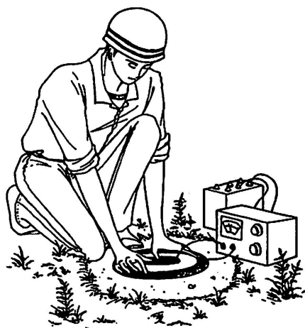
図-2.4.2 比誘電率法の測定状況図
