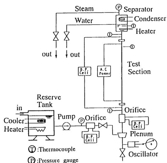
Fig. 1 Experimental apparatus
