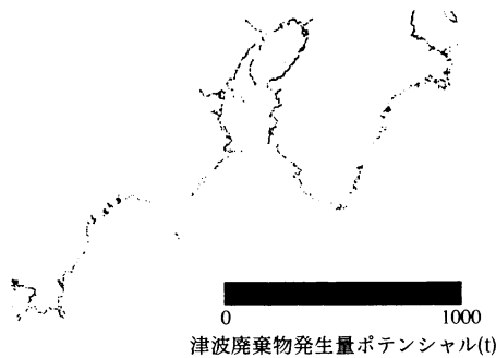
図-4 東南海・南海地震における基準地域メッシュ別の津波廃棄物発生量ポテンシャル
