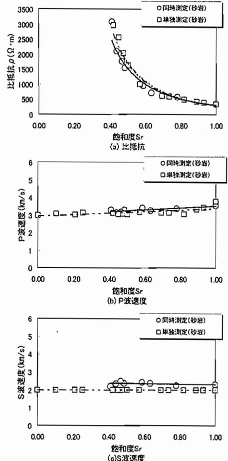
図-9 比抵抗及び弾性波速度比較 (砂岩)
