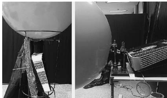
図11 ディスプレイとプロジェクタの支持機構 (左:Aパターン下面支持型 右:Bパターン背面支持型)
