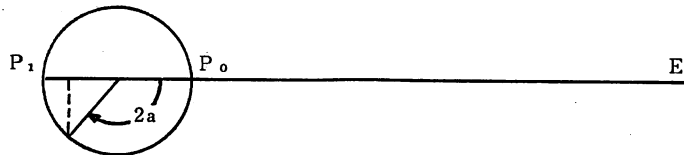
図2 月の軌道の傾斜角を変化させるためのメカニズム。 (V.E. Thoren, Isis , 58—191, p. 32より)。
